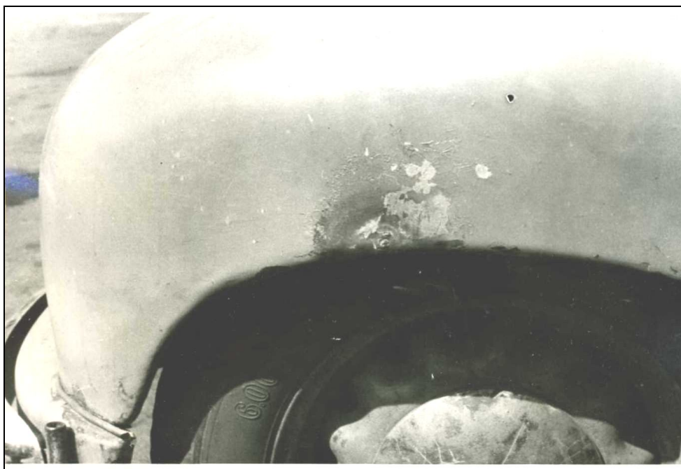
Fot. 6. Jeden z przykładów pęknięcia błotnika przedniego w samochodzie Skoda 1200.
