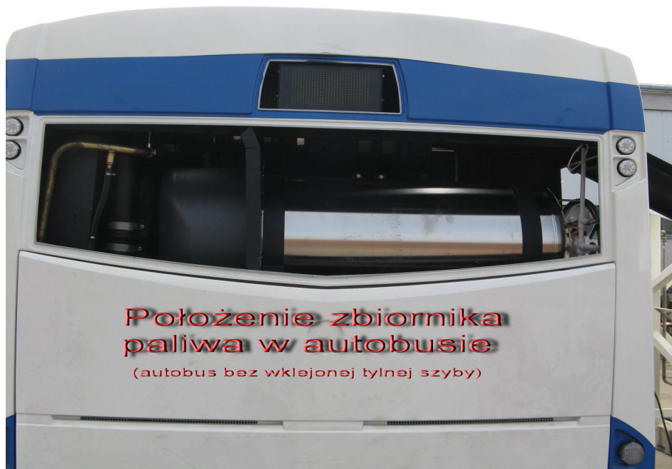
Fot. 6. Sposób usytuowania zbiornika metanu LNG w autobusie
