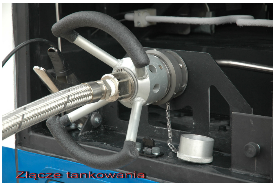
Fot. 10. Zawór tankowania ciekłego metanu - zbiornik gazu umieszczony w autobusie
