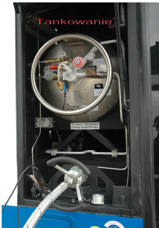
Fot. 9. System tankowania zbiornika LNG – zbiornik gazu umieszczony w autobusie
