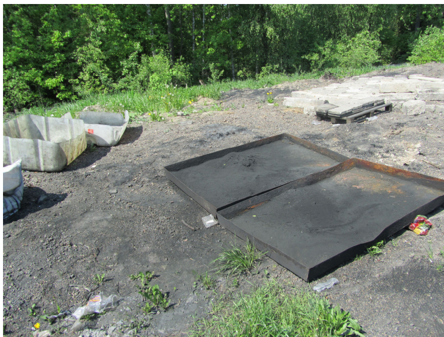
Fot. 3. Produkt uboczny procesu termokatalicznego przerobu odpadów tworzyw sztucznych - węgiel (powstały w procesie karbonizacji) i zanieczyszczenia mineralne.
