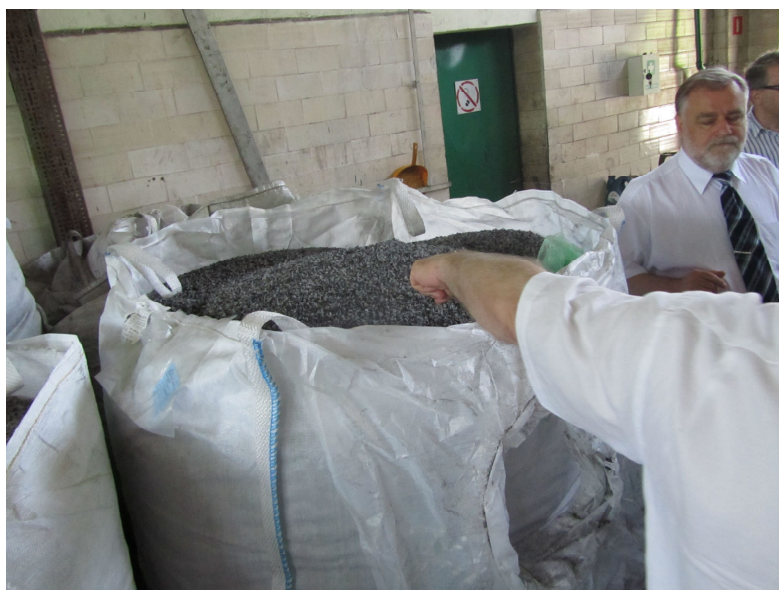
Fot. 1. Wsad do instalacji termokatalicznego przerobu odpadów tworzyw sztucznych - poliolefinowe odpady poprodukcyjne.
