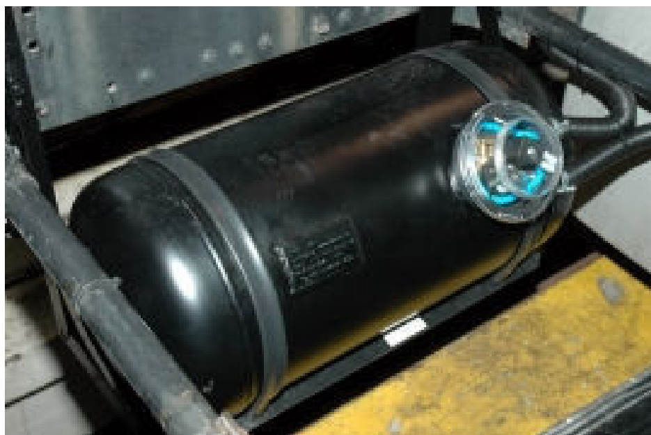
Fot. 5a. Zbiornik gazu LPG zamontowany w samochodzie ciężarowym marki MAN
