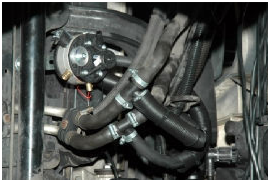
Fot. 5c. Reduktor-parownik w samochodzie ciężarowym marki MAN (przed przednim prawym kołem).
