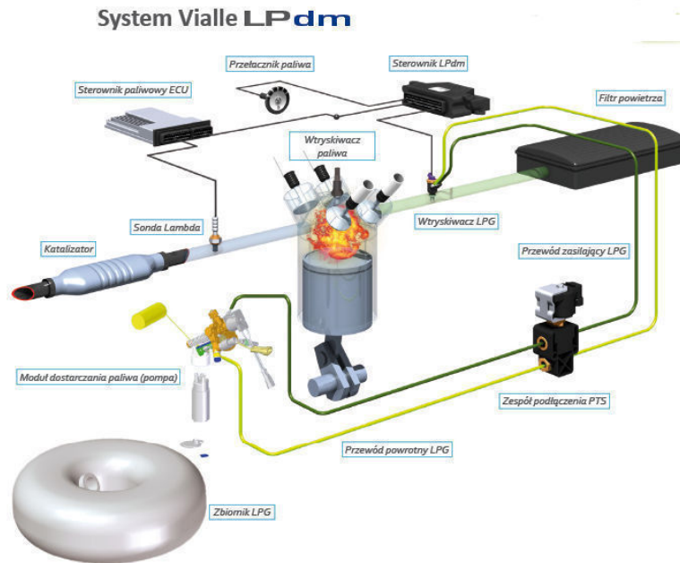
Fot. 17. Schemat instalacji ciekłego wtrysku gazu firmy VIALLE LPdm dedykowanego do silników diesla
