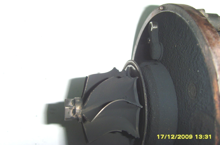
Fot. 10. Uszkodzone łopatki wirnika turbiny
