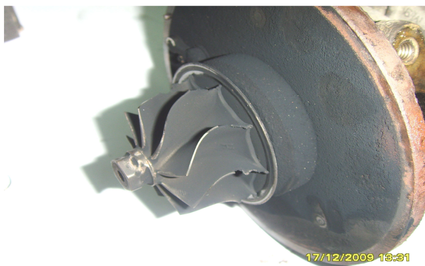
Fot. 9. Uszkodzone łopatki wirnika turbiny
