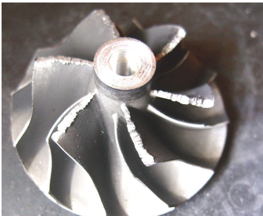
Fot. 6. Mechaniczne uszkodzenie łopatek sprężarki
