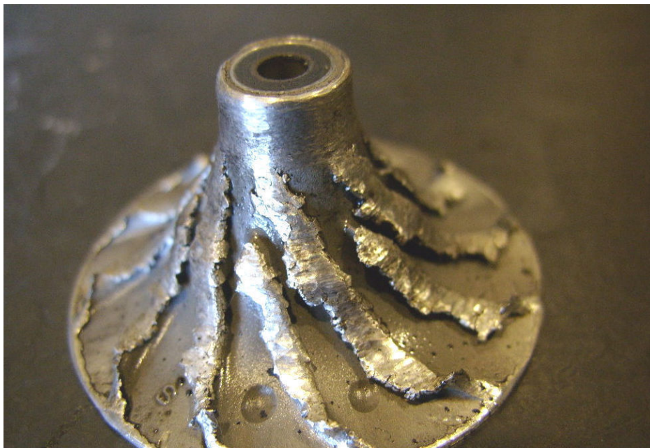
Fot. 8. Mechaniczne uszkodzenie łopatek sprężarki spowodowane przedostaniem się do układu dolotowego silnika dużego, twardego ciała obcego
