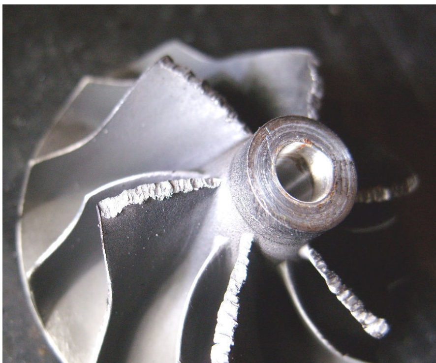
Fot. 6. Mechaniczne uszkodzenie łopatek sprężarki
