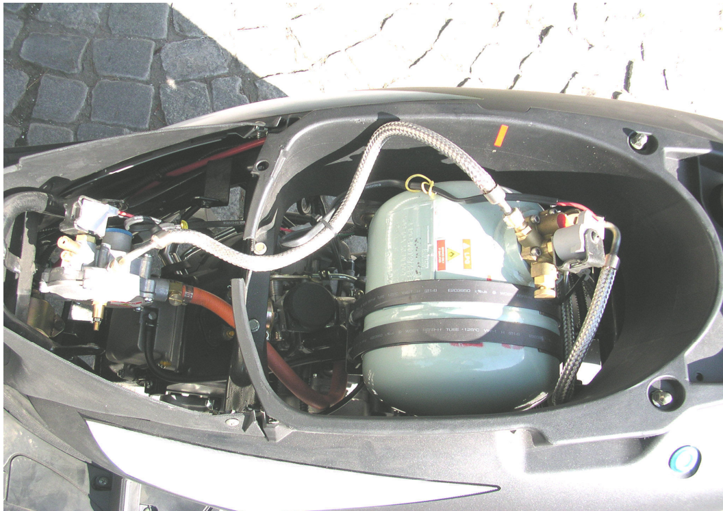
Fot. 11. Linia paliwowa – zbiornik gazu, osprzęt, reduktor
