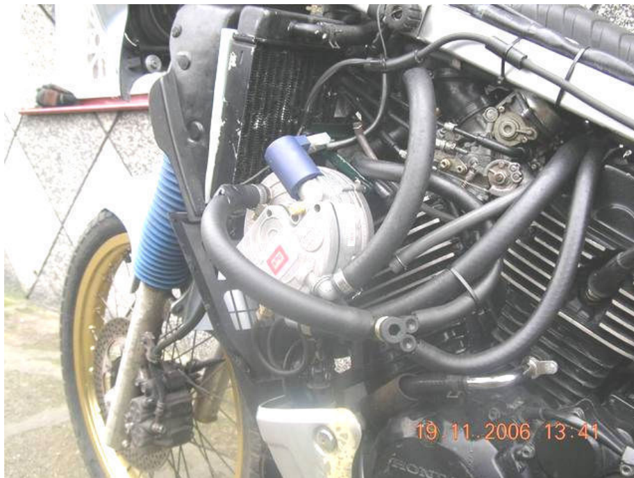
Fot. 2. Reduktor/parownik wraz z przewodami doprowadzającymi gaz oraz ciecz chłodzącą
