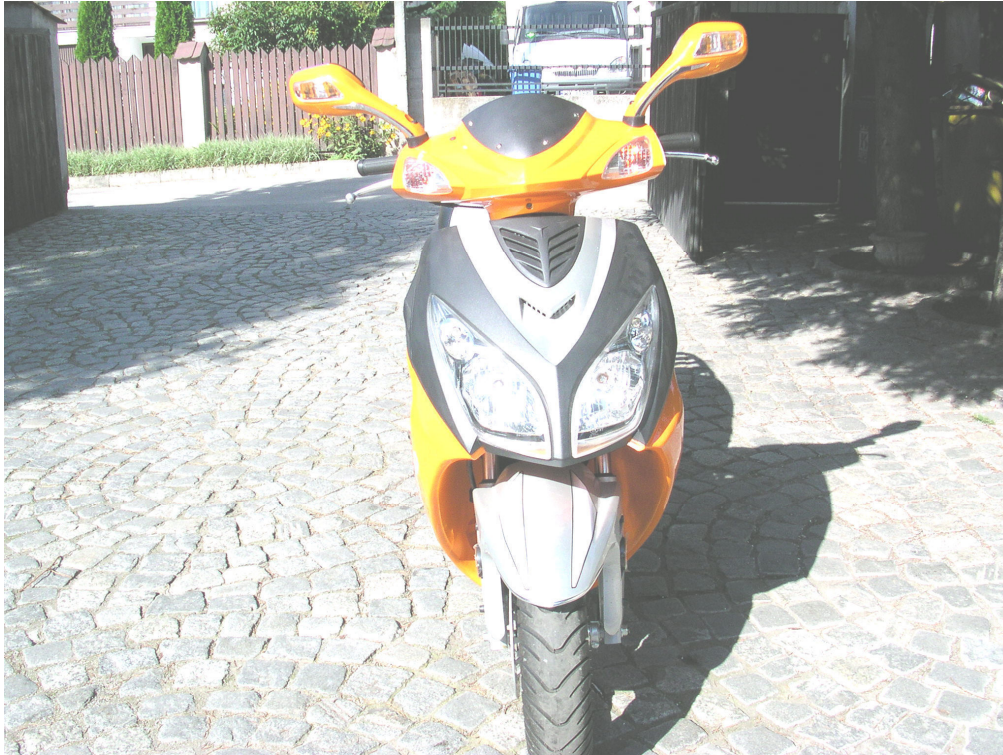
Fot. 5. Motorower fabrycznie przystosowany do zasilania gazem widok z przodu
