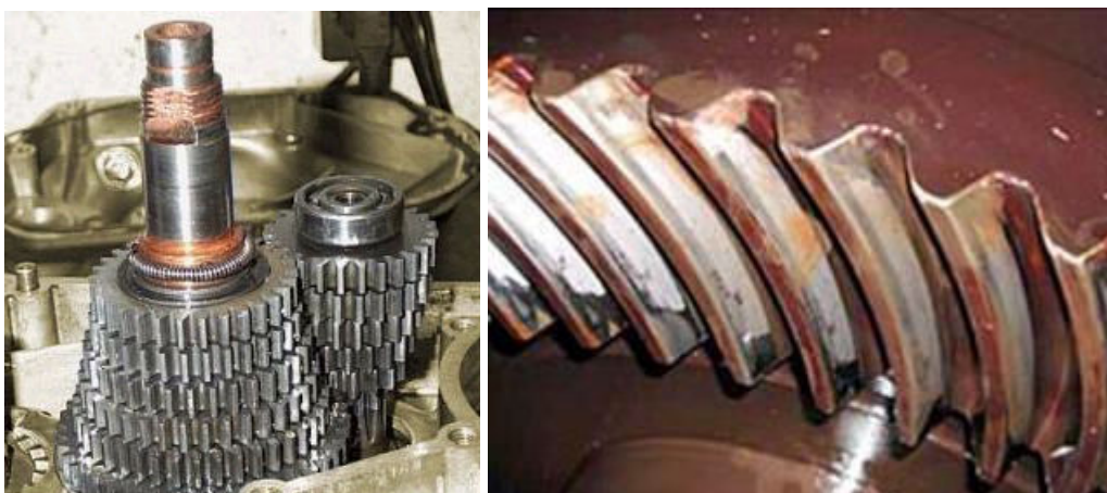
Rys. 4. Przykłady zużycia ściernego i zmęczeniowego
