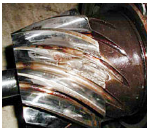
Rys. 3. Wykruszenie całego zęba na skutek nieprawidłowego ukształtowania powierzchni nośnej lub cyklicznych miejscowych przeciążeń przekładni
