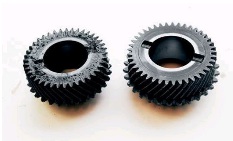
Rys. 2. Wykruszenie czola zębów na skutek niewłaściwej współpracy kół
