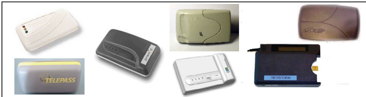
Rys. 2. Urządzenia elektroniczne (transpondery) systemu DSRC
