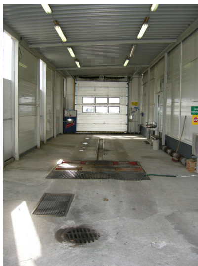
Fot. 4. Stanowisko do kontroli sił hamowania oraz skuteczności działania amortyzatorów
