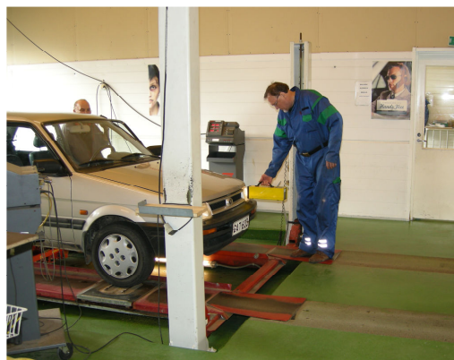
Fot. 3. Przyrząd do kontroli ustawienia świateł
