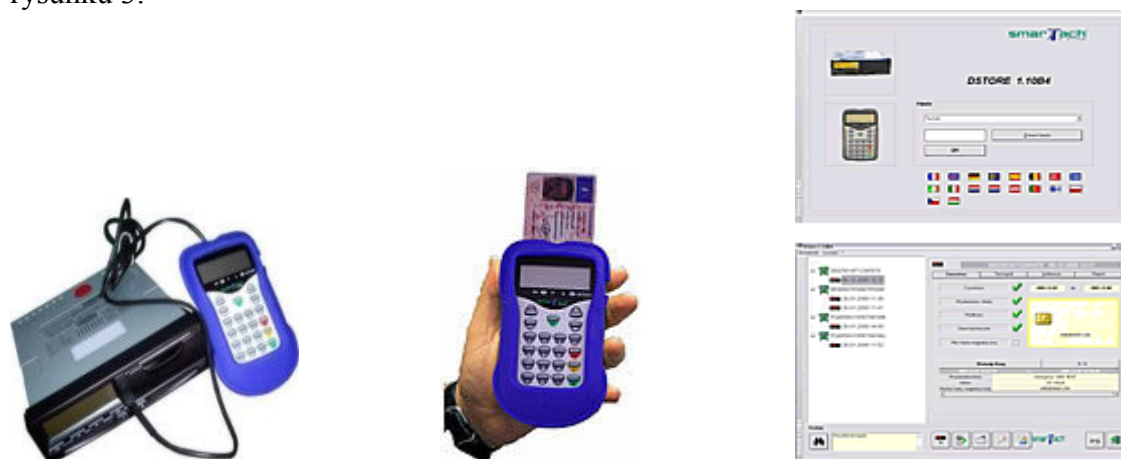
Rys. 3. Zestaw do pobierania danych firmy ACTIA, składający się z urządzenia SmarTach D-Box (USB) i programu TachoStore
