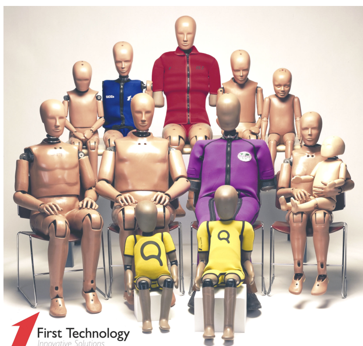
Fot. 1. Rodzina manekinów crash-testowych Hybrid III, stworzona przez inżynierów z firmy First Technology.
